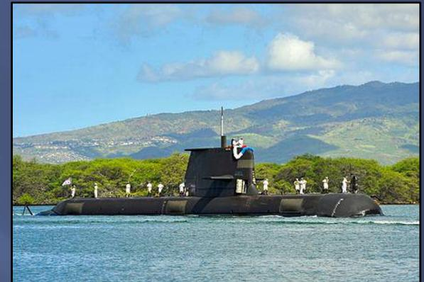
Austral. Collins-Klasse, Verdrängung: 3100/3407 t, Länge: 77,42 m, Breite: 7,8 m, Tiefgang: 7 m, Geschwindigkeit: 10/20 kn, diesel-elektrischer Antrieb, Besatzung: 58, Bewaffnung: 6 Torpedorohre, Minen; Kiellegung: 17.02.1994, Stapellauf: 01.05.1999, Indienststellung: 23.02.2001; Bauwerft: Australian Submarine Corporation, Osborne, Australien. - Brief mit Dienststempel des Kommandanten des U-Bootes aus Adelaide vom 26.11.1998 (Foto: wikipedia)
