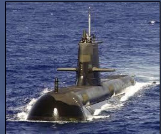
Austral. Collins-Klasse, Verdrängung: 3100/3407 t, Länge: 77,42 m, Breite: 7,8 m, Tiefgang: 7 m, Geschwindigkeit: 10/20 kn, diesel-elektrischer Antrieb, Besatzung: 58, Bewaffnung: 6 Torpedorohre, Minen; Kiellegung: 12.05.1995, Stapellauf: 07.01.2001, Indienststellung: 29.03.2003; Bauwerft: Australian Submarine Corporation, Osborne, Australien. - Brief mit Dienststempel des Kommandanten des U-Bootes aus Adelaide vom 13.04.2004 (Foto: wikipedia)
