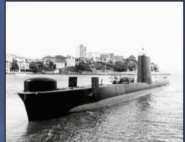
Britische Oberon-Klasse, Verdrängung: 2030/2410 t, Länge: 90 m, Breite: 8,1 m, Tiefgang: 5,5 m, Geschwindigkeit: 12/17 kn, 2 Diesel- und 2 E-Motoren, Besatzung: 64, Bewaffnung: 6 Torpedorohre; Kiellegung: 02.07.1964, Stapellauf: 24.09.1965, Indienststellung: 21.03.1967, Außerdienststellung: 13.02.1993; Bauwerft: Scotts Shipbuilding and Engineering Company, Greenock, UK. - Brief mit Namens- und Bordstempel des U-Bootes aus North Sydney vom 14.03.1972 (Foto: wikipedia)
