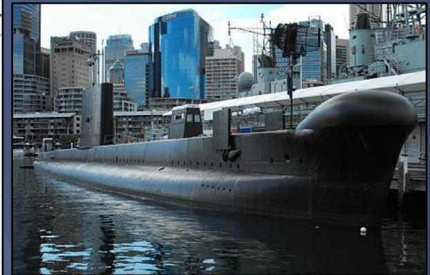
Britische Oberon-Klasse, Verdrängung: 2030/2410 t, Länge: 90 m, Breite: 8,1 m, Tiefgang: 5,5 m, Geschwindigkeit: 12/17 kn, 2 Diesel- und 2 E-Motoren, Besatzung: 64, Bewaffnung: 6 Torpedorohre; Kiellegung: 04.12.1967, Stapellauf: 03.12.1968, Indienststellung: 22.12.1969, Außerdienststellung: 29.03.1999; Bauwerft: Scotts Shipbuilding and Engineering Company, Greenock, UK. - Brief mit Dienststempel des Kommandanten des U-Bootes aus North Sydney vom 19.01.1972 (Foto: wikipedia)
