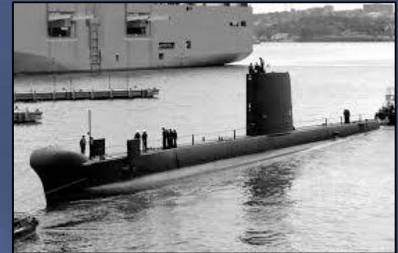
Britische Oberon-Klasse, Verdrängung: 2030/2410 t, Länge: 90 m, Breite: 8,1 m, Tiefgang: 5,5 m, Geschwindigkeit: 12/17 kn, 2 Diesel- und 2 E-Motoren, Besatzung: 64, Bewaffnung: 6 Torpedorohre; Kiellegung: 25.05.1973, Stapellauf: 03.12.1975, Indienststellung: 27.04.1978, Außerdienststellung: 15.12.2000; Bauwerft: Scotts Shipbuilding and Engineering Company, Greenock, UK. - Brief mit Dienststempel des Kommandanten des U-Bootes aus Sydney vom 28.01.1999 (Foto: wikipedia)
