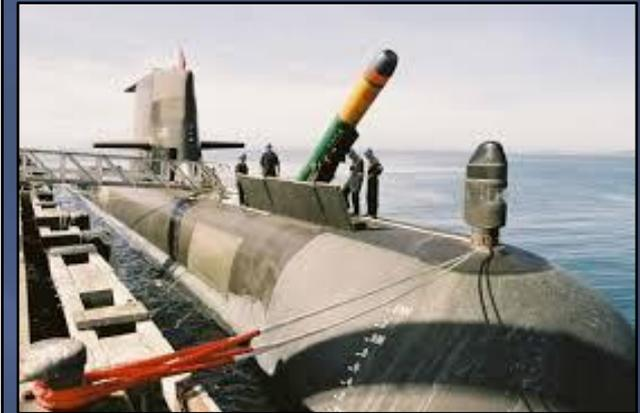
Austral. Collins-Klasse, Verdrängung: 3100/3407 t, Länge: 77,42 m, Breite: 7,8 m, Tiefgang: 7 m, Geschwindigkeit: 10/20 kn, diesel-elektrischer Antrieb, Besatzung: 58, Bewaffnung: 6 Torpedorohre, Minen; Kiellegung: 04.03.1993, Stapellauf: 12.03.1998, Indienststellung: 23.02.2001; Bauwerft: Australian Submarine Corporation, Osborne, Australien. - Brief mit Dienststempel des Kommandanten des U-Bootes aus Adelaide vom 16.10.1997 (Foto: wikipedia)
