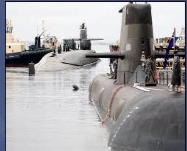
Austral. Collins-Klasse, Verdrängung: 3100/3407 t, Länge: 77,42 m, Breite: 7,8 m, Tiefgang: 7 m, Geschwindigkeit: 10/20 kn, diesel-elektrischer Antrieb, Besatzung: 58, Bewaffnung: 6 Torpedorohre, Minen; Kiellegung: 07.02.1992, Stapellauf: 14.03.1997, Indienststellung: 10.07.1999; Bauwerft: Australian Submarine Corporation, Osborne, Australien. - Brief mit Dienststempel des Kommandanten des U-Bootes aus Adelaide vom 22.09.1997 (Foto: wikipedia)
