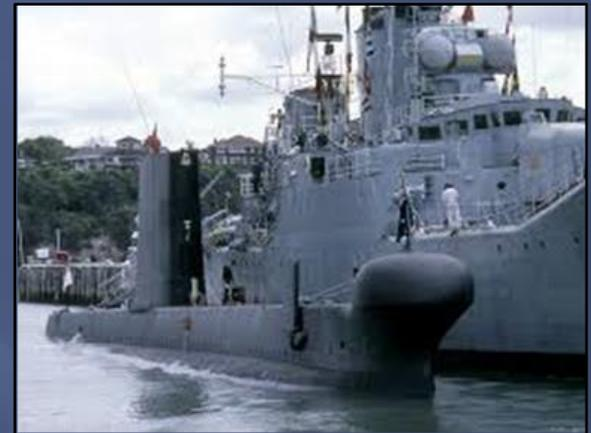
Britische Oberon-Klasse, Verdrängung: 2030/2410 t, Länge: 90 m, Breite: 8,1 m, Tiefgang: 5,5 m, Geschwindigkeit: 12/17 kn, 2 Diesel- und 2 E-Motoren, Besatzung: 64, Bewaffnung: 6 Torpedorohre; Kiellegung: 29.06.1965, Stapellauf: 29.11.1966, Indienststellung: 23.04.1968, Außerdienststellung: 17.02.1994; Bauwerft: Scotts Shipbuilding and Engineering Company, Greenock, UK. - Brief mit Dienststempel des Steuermann des U-Bootes aus Adelaide vom 30.09.1968 (Foto: wikipedia)
