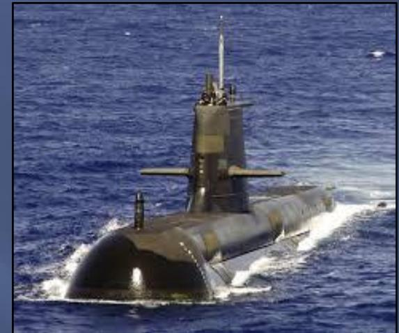
Austral. Collins-Klasse, Verdrängung: 3100/3407 t, Länge: 77,42 m, Breite: 7,8 m, Tiefgang: 7 m, Geschwindigkeit: 10/20 kn, diesel-elektrischer Antrieb, Besatzung: 58, Bewaffnung: 6 Torpedorohre, Minen; Kiellegung: 14.02.1990, Stapellauf: 28.08.1993, Indienststellung: 27.07.1996; Bauwerft: Australian Submarine Corporation, Osborne, Australien. - Brief mit Dienststempel des Kommandanten des U-Bootes aus Perth vom 29.10.1997 (Foto: wikipedia)
